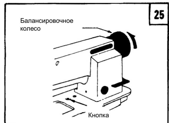
б. В случае остановки махового колеса стопорной плитой для поворота колеса с целью возврата предохранительной муфты в исходное положение требуется большее усилие.
